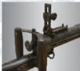
トリガーはプッシュ式で、スベード・グリップの基部上部にはセーフティ・レバーが設けられています。
