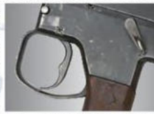
コッキング操作はグリップを前後にスライドさせて行います。グリップ着用時に操作しやすいよう、トリガーとトリガーガードは大型となっています。
