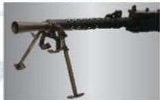
二脚基部には、二脚を折り畳んだ状態で前方の支えとして使用する「ハイボッド・レスト・レッグ」式と呼ばれる脚を備えています。
