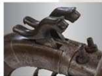
本銃は1本のトリガーのみで左右のハンマーを撃ち分ける構造となっています。
