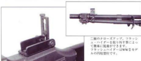
M1918A2のリア・サイトのクロースアップ。30口径機関銃と同型のリア・サイトが使用されています。
