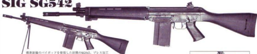
標準装備のバイポッドを使用した状態のSG542。プレス加工のバイポッドは折り畳み時はハンドガードの一部となるようにデザインされており、バイポッドを装着している際と合致しません。
