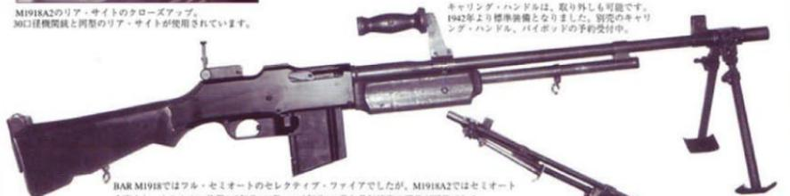
BAR M1918ではフル・セミオートの設定タイプ・ファイアでしたが、M1918A2ではセミオートを廃止し、セクター位置Sで毎分550発、Aで毎分350発と発射速度の調整が可能でした。
