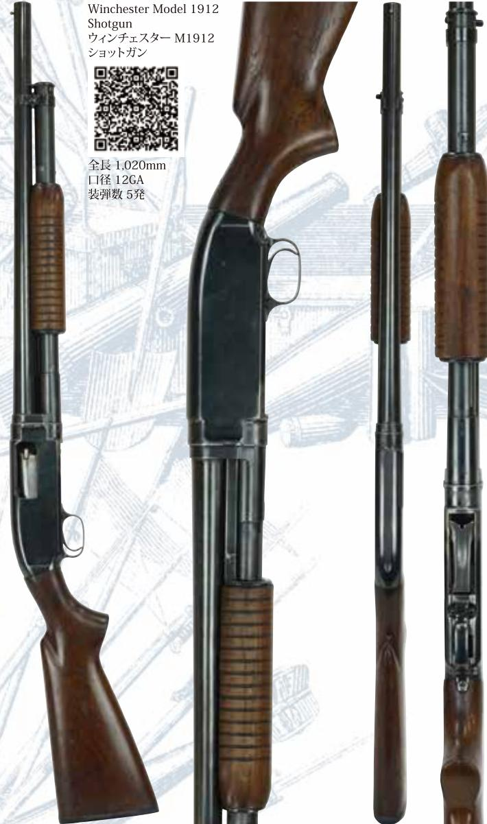
ワインチェスター M1897の改良型として発表されたポンプ・アクション式ショットガンです。M1897の完成度は高かったものの、外装式ハンマーゆえに開口部が多く、異物侵入による作動不良を起こす可能性がありました。また、ブリーチ・ボルトが後退する構造は、グリップ方法を誤ると後退したボルトが射手の手に衝突する恐れがありました。これらの欠点を改善する為、トマス・C・ジョンソンにより再設計が行われ、ハンマー内蔵式としてボルトの作動範囲をレシーバー内に収めた他、開口部を排莢孔と装填孔に絞る事により、作動の信頼性や操作性が高められました。更に口径や銃身・薬室長の他、装備や仕上げの異なるグレード展開が行われて様々な需要に対応した事により、米国内外で官民間わざ高い人気を博し、1964年に製造が終了するまで約200万挺が製造されました。米軍では陸軍や海兵隊がM1897と併せて多数調達した他、海軍や陸軍航空隊の警備任務にも用いられました。
