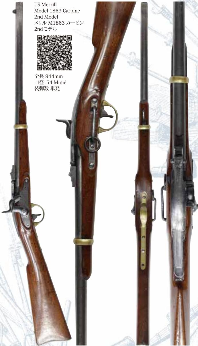
1858年にジェームズ・H・メリルによって設計された.54口径の単発後装管打式騎兵銃です。レシーバー上部のブリーチ・レバー両側のラッチを後方に引いてロックを解除し、ブリーチ・レバーを後方上部に大きく起こして装填を行う特殊な構造となっています。ブリーチ・レバーを完全に開放すると、弾薬を薬室内に押し込むブランジャーも運動して後退し、弾薬の装填が可能となります。装填後に再度ブリーチ・レバーを前方に戻すと、ブランジャーが前方に移動して弾薬が薬室内に送り込まれます。撃発は本体右側面のサイド・ロッドにあるハンマーがニップル上に取り付けられた雷管を叩いて行います。1stモデルではバット・ストック右側面に真鍮製のバッヂ・ボックスが設けられており、ブリーチ・レバー両側のラッチがチェックリングの入った板状でしたが、2ndモデルではバッヂ・ボックスが省略され、ラッチがボタン型に変更されました。
