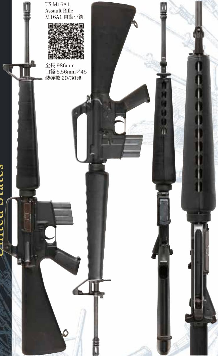
米国アーマライト社のユージン・ストーナーが設計し、コルト社が製造を行って1962年に米空軍が採用したM16（コルト社内モデル名AR-15・M601）の改良型です。1967年にそれまでの仮製式名であるXM16E1に代わり、M16A1の陸軍制式名が与えされました。M16A1（コルト社内モデル名M603）は、仮製式モデルであるXM16E1（陸軍向けM602）と同様にボルト・フォワード・アシストを備えており、マガジンから薬室への装填不良が発生した際にもボルトを手動で前進させる事が可能となっています。M16A1ではマガジン・リリース・ボタンの誤操作を防ぐ為のリップが追加された他、ボルトを始め内部部品が強化されました。M16A1はベトナム戦争拡大に伴う大量の需要に応える為、コルト社以外にもゼネラル・モータースのハイドロ・マチック・ディビジョン及びハーリントン＆リチャードソン社でも生産が行われました。また、輸出向けとしても大量に生産され、これらの輸出向けM16A1にはM613のコルト社内モデル名が与えられました。
