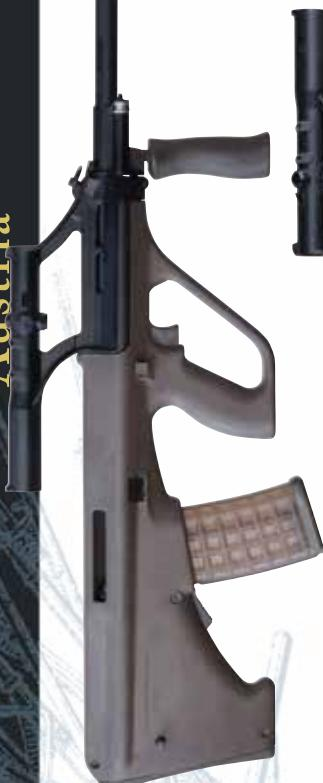
ステアー AUG A2 自動小銃をベースに開発された分隊支援火器モデルで、連続射撃に対応した銃身長621mmのヘビーバレル及び二脚が標準装備されています。ベースとなったステアー AUG はオーストリアのステアーマンリッヒャー社が開発したブルバップ型の自動小銃です。ステアーハンドルに設けられたボタンを押す事によりコッキング・ハンドルとボルト・グループが連結されてボルト・フォワード・アシストとして機能しましたが、1997年に登場したAUG A2ではコッキング・ハンドルを倒す事により機能するよう改良されました。また、スコープ内蔵のキャリング・ハンドルを取り外してピカティニー・レールへの交換が可能となっているのも特徴です。ステアーハンドルと同様にヘビーバレルと二脚を装備するAUG LMGと呼ばれる軽機関銃モデルも存在しますが、ヒヤーのメーカー名及びAUGのモデル名がこちらはオープン・ボルト位置から射撃を行うトリガー・ユニットになっています。
