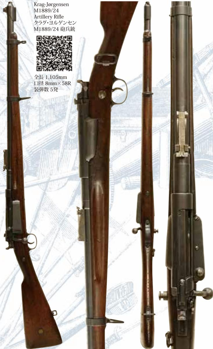
ノルウェーのOle H. J. KragとErik Jørgensenが開発した特殊な装填機構を持つボルト・アクション・ライフルで、弾薬の装填はレシーバー右側面にあるハッチを開いて一発ずつ行います。デンマーク軍用モデルはドイツのGew.88小銃と同様、銃身にバレル・ジャケットを装備し、フローティング・バレルとする事で命中精度の向上を図っていました。デンマークでは最初にM1889小銃が採用された後、これを基に複数のバリエーションが開発され、1924年にはM1889/10歩兵銃を縮短したM1889/24砲兵銃が採用されました。基本的な仕様はM1889/23騎兵銃と同様ですが、銃口付近に着剣装置を下部に備えたキャップが追加されている他、銃床の一部に木部の埋木が行われているなど、歩兵銃の名残が見られます。騎兵銃と同様、スリング・スイベルは左側面にも設けられ、ボルト・ハンドルは下方に曲げられています。デンマークは1940年にドイツ軍占領下に置かれるまでクラグ・ヨルゲンセン小銃を第一線で使用しました。
