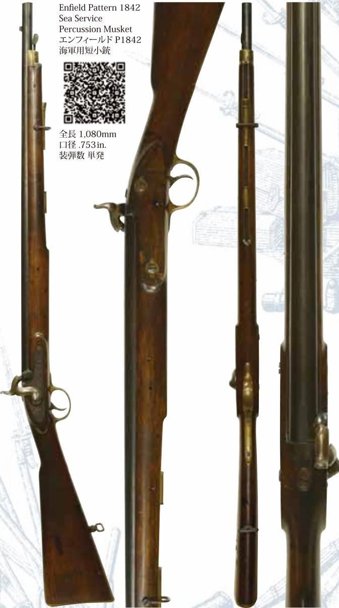
通称「タワー・ライフル」とも呼ばれる、エンフィールド型のサイド・ロックを持ち、銃身内にライフリングのない滑腔銃身を備えた前装管打式小銃のバリエーションの一つです。1839年にそれまでのフリント・ロック小銃をベースにバーカッション・ロックに改造されたのがP1839小銃で、サイド・プレートにフリント・ロックの名残がありました。P1842は1842年に英軍制式となったモデルで、当初から前装管打式として製造された英軍初の小銃です。その中でもP1842海軍用短小銃は2バンド小銃と騎兵銃の中間サイズのモデルです。滑腔銃身で射程も短かったためリア・サイトではなく、散弾銃の様にフロント・サイトと銃身上の線で照準を行いました。銃口付近の銃身下部に独特のレバー式着剣装置が付いており、古いタイプのソケット型銃剣を装着可能であった事から、ミニエー弾を使用する施条銃の制式化後も、最新式の陸上装備を必要としない海軍用として長らく使用されました。
