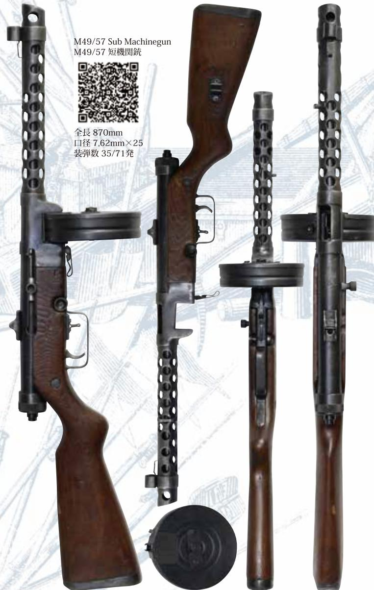
第二次世界大戦後、ユーゴスラビアでは国産短機関銃の独自開発が進められ、1949年にM49と呼ばれるモデルが開発されてクラグイェヴァツ(Kragujevac)のツアスターで製造が開始されました。M49短機関銃の外観は旧ソ連のPPSh-41短機関銃に類似しており、弾倉も互換性が有りましたが、円筒形一体型の機関部やバッファー、左側に開いたエジェクション・ポート等にはイタリアのベレッタM1938系短機関銃の影響を受けしていました。また、銃床下部にはクロス・ボルト・セーフティが追加されているのも特徴です。さらにフロント・サイトにはドイツのKar.98k小銃に類似したU字型の保護カバーが装備されている他、円形のコッキング・ハンドル形状など特徴の多い短機関銃でした。M49/57短機関銃はM49に小改良を加えたモデルで、複雑なボルト・ユニットが一般的なボルトとリコイル・スプリングの組み合わせへと簡略化されました。M49/57は、後継のM56短機関銃が登場した後も一定数の製造が続けられました。
