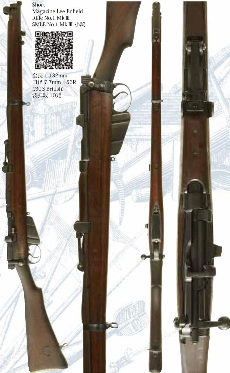
SMLE No.1 Mk Iを改良して1907年に英軍制式となったボルト・アクション・ライフルです。SMLE小銃はボルトのロッキング・ラグが同時期の他のボルト・アクション・ライフルと比較して後部に配置されていた為、ボルト・ストロークが短く速射性に優っていました。No.1 Mk IIIではリア・サイトが簡略化された他、No.1 Mk Iではボルト・ヘッドに設けられていたクリップ・チャージャー機能が本体側に移されました。また、ハンドガードやマガジンのデザインも変更され、薬室形状も高初速の尖頭弾であるMK VII弾を使用出来るよう改良が加えられています。イギリスでの製造は1943年まで行われましたが、インド、オーストラリアでは50年代まで生産が続けられました。SMLE No.1小銃はその後、第二次世界大戦中期以降のイギリス軍主力小銃となったNo.4小銃への更新が徐々に行われましたが、最終的にはL1A1自動小銃が採用されるまで、シリーズを通して実に約60年間主力小銃であり続けた英軍を代表する名銃です。
