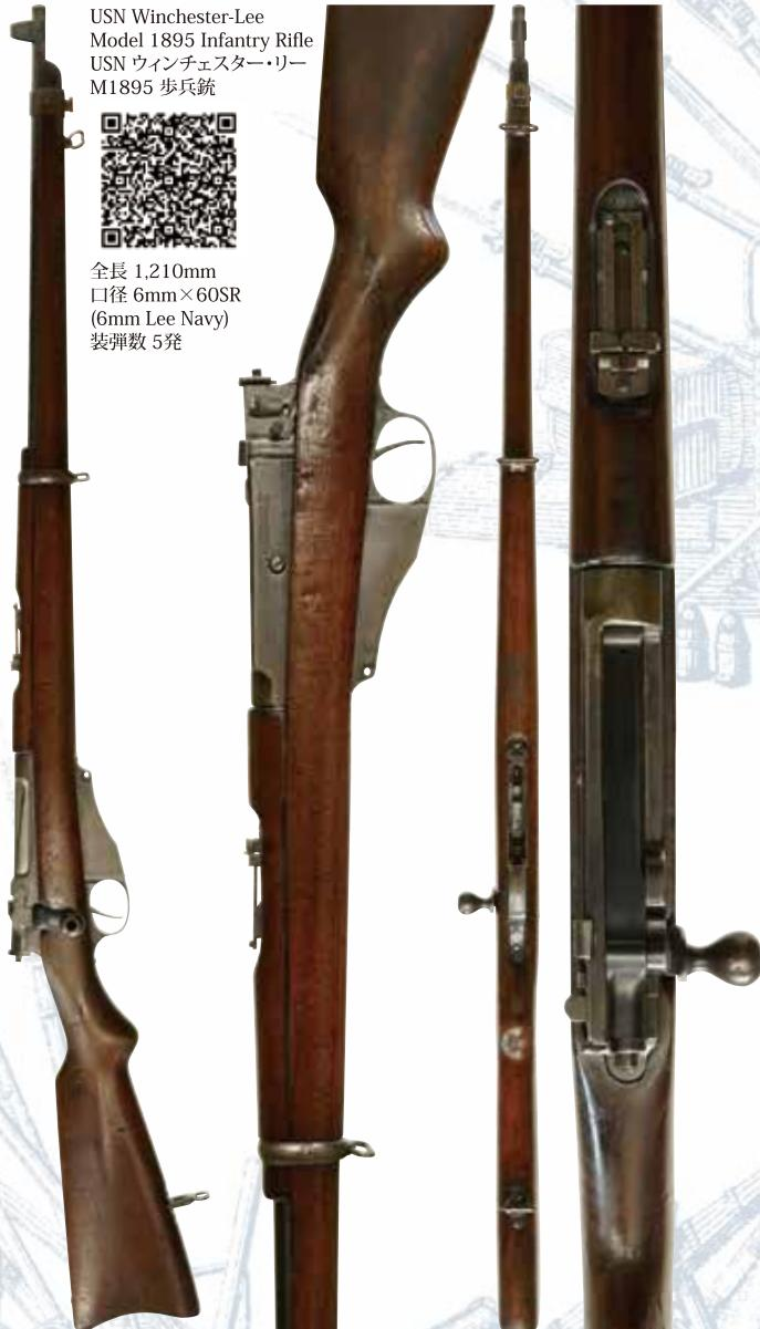
米海軍部隊及び海兵隊用として1895年に採用された連発式小銃で、1894年まで米国海軍独自で研究が進められていた小口径無煙火薬弾を使用します。5発用のクリップにより装弾を行うシングル・カラムの固定式弾倉を備えており、特殊なカム・アクション・ストレート・ブルと呼ばれるボルト・アクション機構により作動します。この方式ではボルト・ハンドルを若干持ち上げ気味に後方に引く事により、ボルトがレシーバーのウェッジ・ロックから開放される構造となっています。本銃のストレート・ブル方式は速射性に優れている事が評価されましたが、1898年初頭の海兵隊によるキューバでの実戦使用の結果、ファイアリング・ピン・ロックとボルト・ロック・アクチュエータの脆弱さが第一線兵器としては不適格である事が判明しました。本銃は海兵隊では1900年1月にクラグ小銃により全て置き換えられましたが、海軍では1920年代まで海外派遣される艦艇に装備されていました。
