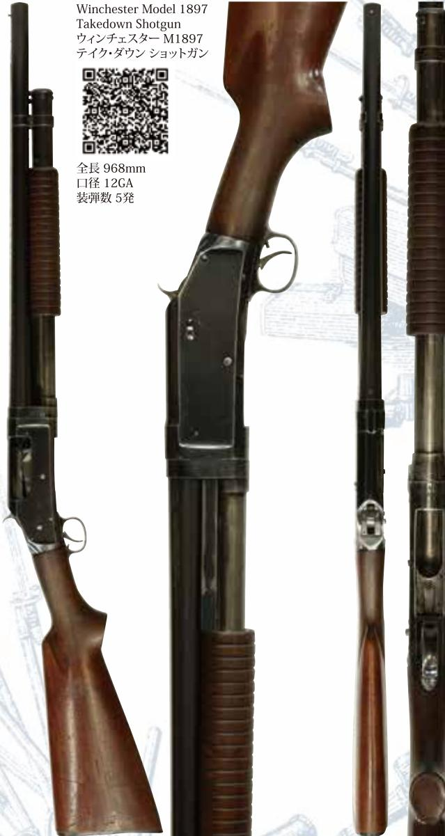
ワインチェスター社による初のポンプ・アクション式ショットガンであるM1893の改良型として、1897年に発表されたモデルです。設計者はジョン・M・ブローニングで、M1893の基本設計を引き継ぎながらも、当時急速に普及しつつあった無煙火薬仕様の装弾に対応する為、レシーバーの強度を高めた他、装填や排莢の確実性を高めるためシェル・ガイドやエジェクション・ポート形状にも改良が加えられました。また、誤操作による暴発を防ぐ為、アクション・スライド・ロックが導入され、安全性も高められています。これらの改良によりM1897は高い信頼性を誇り、バランスのとれたデザインも相まって発売初期から大きな人気を博してその地位を確固たるものとしました。M1897は当初ソリッド・フレーム・モデルが基本仕様として発売されました。その後バレルとレシーバーを分割可能なテイク・ダウン・モデルも発売され、1957年に生産が終了するまでに100万挺以上製造されました。
