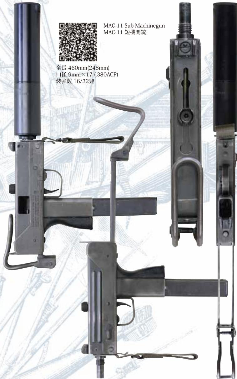
ゴードン・B・イングラムにより特殊部隊用に開発された小型短機関銃で、9mm×19弾もしくは.45 ACP弾を使用するMAC-10短機関銃とともに米国のMAC社 (Military Armament Corporation)で製造が行われました。.380ACP弾を使用するMAC-11短機関銃では、MAC-10に比べて本体サイズが大幅にスケール・ダウンされています。尚、スケール・ダウンによりボルトの後退量が短くなつた事から、発射速度は約1,200発/分と非常に高速となりました。基本構造としてはイスラエルのUZI短機関銃と同様に、L型のテレスコピング・ボルトのメリットを最大限に利用したコンパクトな設計となつており、プローパック方式によりオープン・ボルト位置から射撃を行います。また、設計当初からMAC社傘下のSIONICS製サイレンサーを装着出来るよう設計されているのも特徴です。MAC社ではMAC-10及びMAC-11の生産を1973年に終了し1975年に倒産しましたが、その後も製造権を引き継いだ複数のメーカーにより生産が続けられた他、派生モデルやコピー品が製造されました。
