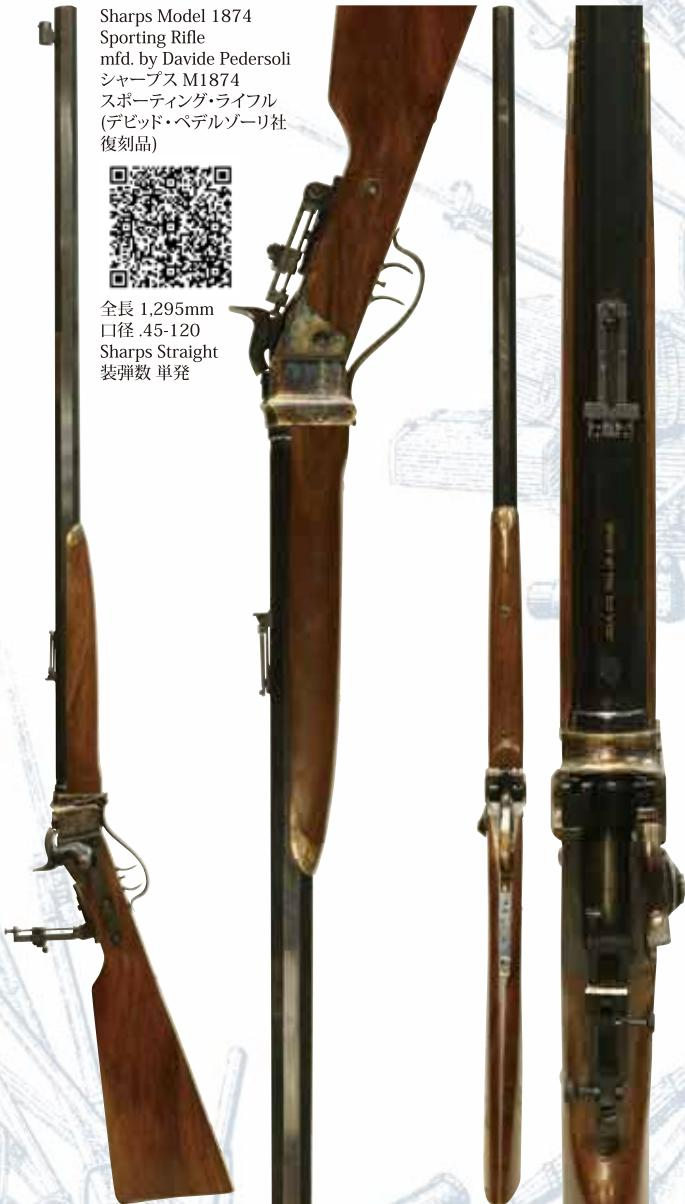
シャープス小銃はクリスティアン・シャープス (Christian Sharps) により1840年代に設計された南北戦争時の代表的なライフルの一つです。シャープス小銃は単発ながら耐久性が高く、南北戦争後も金属薬莢を使用するリム・ファイアやセンター・ファイア仕様に改造成されて使用が続けられた他、当初からセンター・ファイア仕様として製造された品も存在します。本品はイタリアのデビッド・ペデルゾーリ社がセンター・ファイアのM1874スポーティング・ライフルを復刻した品で、2000年に同社で生産された特別生産品である事を示す「dp2000」のロゴが入っています。現代の長距離射撃に対応する為、使用弾薬は黒色火薬を使用する大口径の.45-120弾となっており、肉厚のオクタゴン・バレルとダブル・セット・トリガーを装備しています。リア・サイトは銃身上部のラダー・サイトに加えてロング・レンジ・ピーブ・サイトが装備されており、フロント・サイトにはチューブ型のガードが取り付けられています。
