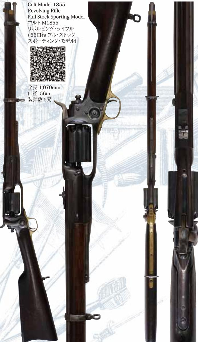
コルト "ニュー・モデル" リボルビング ライフルとも呼ばれる、コルト社が1855年から1864年頃にかけて製造した初期の連発式ライフルです。機械的にはコルト M1855 サイド・ハンマー ポケット・リボルバーを拡大したもので、口径や銃身長の異なるライフル・モデル及びカービン・モデルが軍用若しくはスポーツ用として製造されました。本品は1858年以降に生産が本格的に開始された、.56口径モデルで、口径の拡大に伴いフレーム・サイズが大型化された他、装弾数も6発から5発に変更されました。銃身長は24インチで、フォア・エンドが銃口付近まで伸びたフル・ストック・タイプのスポーツティング・モデルです。フォア・エンド内には分割式クリーニング・ロッドの前部(鉄製)を収納加工となっており、クリーニング・ロッドの延長部(真鍮製)はバット・ストック内のコンパートメントに収納されました。リア・サイトは3段階で切り替え可能な起倒式となっています。
