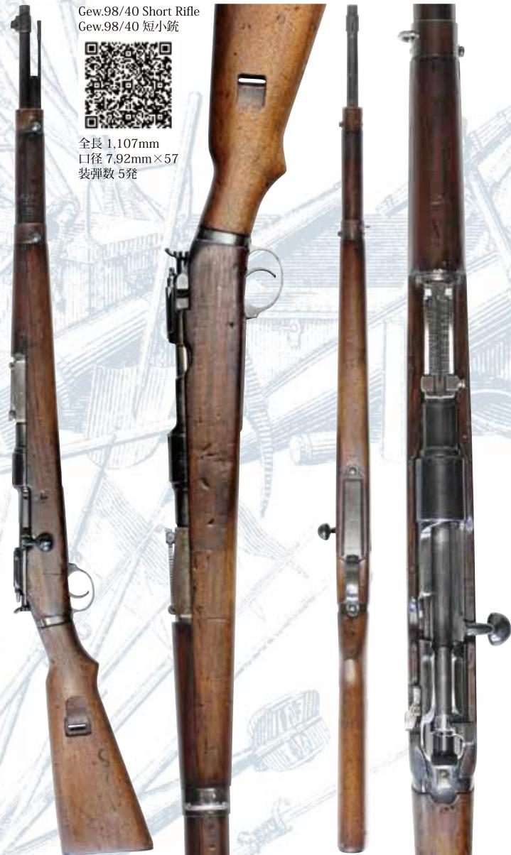
1935年にハンガリー軍制式となった35M小銃を基に、第二次世界大戦中にドイツ軍向けとして改良を加え製造したモデルです。原型である35M小銃は、オーストリアのマンリッヒャー小銃の影響を受けていますが、ボルトの構造がストレート・ブル方式から一般的な回転式に変更されている他、銃床が二分割構造となっています。機関部後部にはマンリッヒャー方式と同様のコッキング・ビースが備えられており、ボルト・ハンドルを操作する事なくコッキング操作が可能ですが、尚、弾倉の構造及びクリップによる給弾方法はモーゼル方式となっています。ドイツでは35M小銃の使用弾薬を7.92mm×57弾に変更し、ボルト・ハンドルや銃剣、スリング取り付け部の形状をKar.98k小銃と同規格に変更する等の改良を施したモデルをGew.98/40の名称で使用しました。Gew.98/40は1941年から1944年にかけてハンガリー・ブダペストのFÉG及びダヌビア機械工場で138,400挺が製造され、ハンガリーでも小改良型を43M小銃として採用されました。
