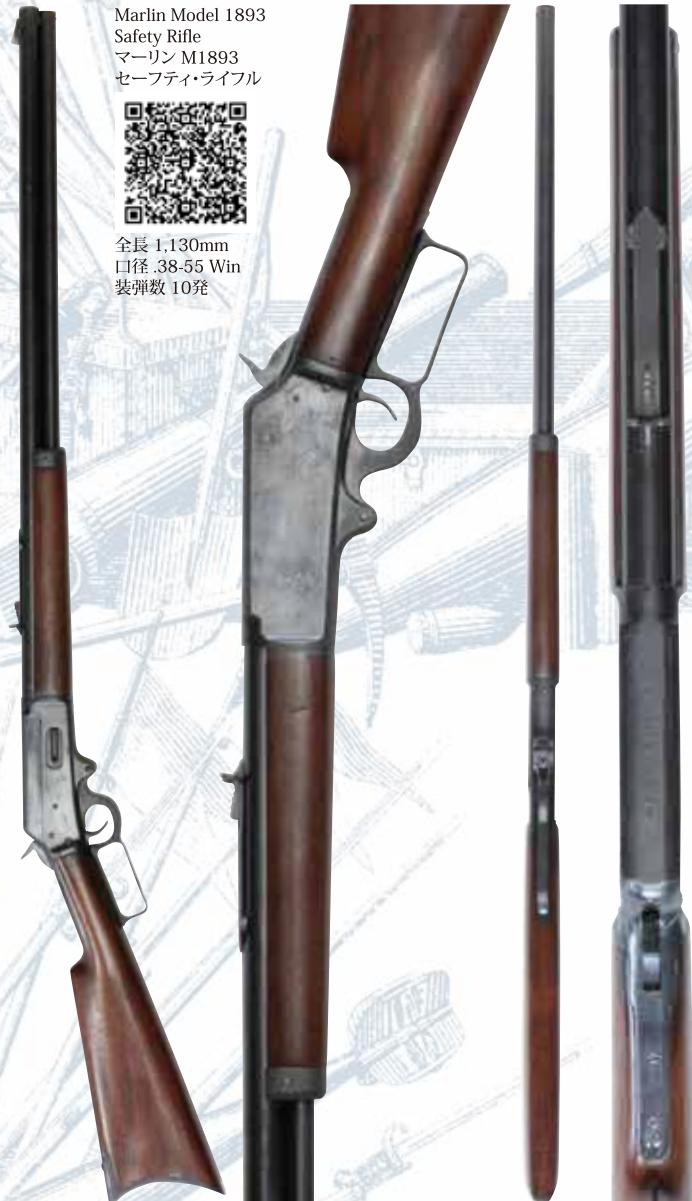
ウィンチェスター社のM1894とほぼ同時期に米国のマーリン社で生産が開始され、構造的にも近い事からライバルとして語られる事も多いレバー・アクション・ライフルです。1881年にマーリン社はウィンチェスター社に先駆けて.45-70 Government等の強力なライフル弾が発射可能なM1881を発表し、1892年までに約2万挺を生産しましたが、1893年からはその後継機種としてM1893の生産が開始されました。ウィンチェスターM1894ではボルト後退時にレシーバー上部が開放されるのに対して、マーリンM1893ではレシーバー右側面上部が開放される構造であった事から、雨や異物侵入防止の観点から有利となっていました。マーリン社はこれを安全性と結び付け、機関部上部に「MARLIN SAFETY」という刻印を入れてウィンチェスター社製のレバー・アクション・ライフルに対抗しました。M1893はマーリン社が製造したレバー・アクションの中で最も人気のあったモデルの一つで、1893年から1936年まで100万挺以上が生産されました。
