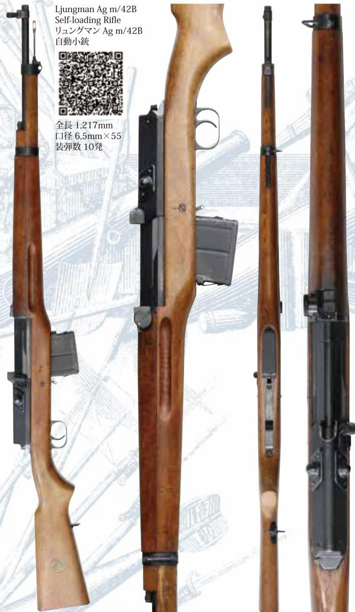
スウェーデンの Erik Eklund が設計し、1942 年に制式化された Ag m/42 自動小銃の改良型です。Ag m/42 の作動方式は、ガス・チューブを通して発射ガスを直接ボルト・キャリアに吹き付けて後退させる当時としては斬新なダイレクト・インピングメント式で、この構造は「リュングマン式」としても知られています。Ag m/42 は制式化後、ガス・チューブの腐食など幾つかの問題点が指摘され、1953 年から 1956 年にかけて既存の Agm/42 に改修を加えたモデルが Ag m/42B として新たに制式化されました。Ag m/42B ではガス・チューブがステンレス製に変更された他、リア・サイトやマガジン、クリーニング・ロッド等にも改良が加えられました。Ag m/42B はデンマークやエジプトでも採用され、エジプトでは 1950 年代初頭に製造ライセンスを取得し、7.92mm×57 モーゼル弾を使用するモデルがハキム自動小銃の名で軍に採用されました。尚、スウェーデンでは 1960 年代半ばに AK4 自動小銃により更新されるまで使用されました。
