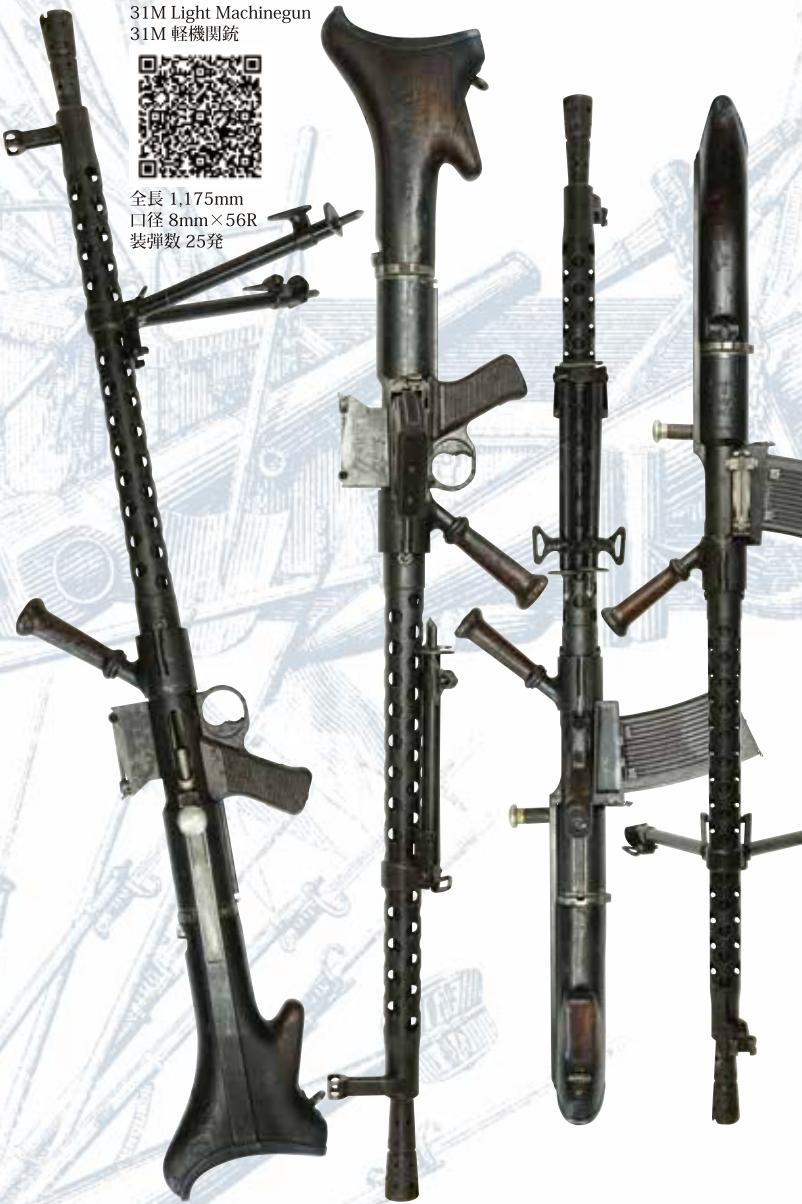
戦間期にドイツのラインメタル社で設計されたMG30軽機関銃をハンガリー軍が採用したモデルです。当時ドイツはヴェルサイユ条約により機関銃の製造を禁止されていたため、部品供給はオーストリアのステアー社、最終的な組み立てはスイスのソロターン社で行なわれました。給弾方式も同条約による制限のため、ベルト給弾ではなく箱型弾倉となっています。作動方式はショット・リコイルの反動利用式で、上下二段式のトリガーによりセミ/フル・オートマチック射撃の切り替えが可能でした。1930年にオーストリアがMG30と同型のM30Sを制式とし、翌年の1931年にハンガリーも31Mを採用しました。M30Sと31Mは基本的に同型ですが、31Mではハンド・ジャケット基部に前方に傾斜した形状のグリップが追加されています。またトリガーのセレクター表示や安全装置の表記が異なっている他、三脚の長さや固定方法も異なります。ハンガリー仕様の31Mの生産数は僅か2,000～3,000挺程と言われています。
