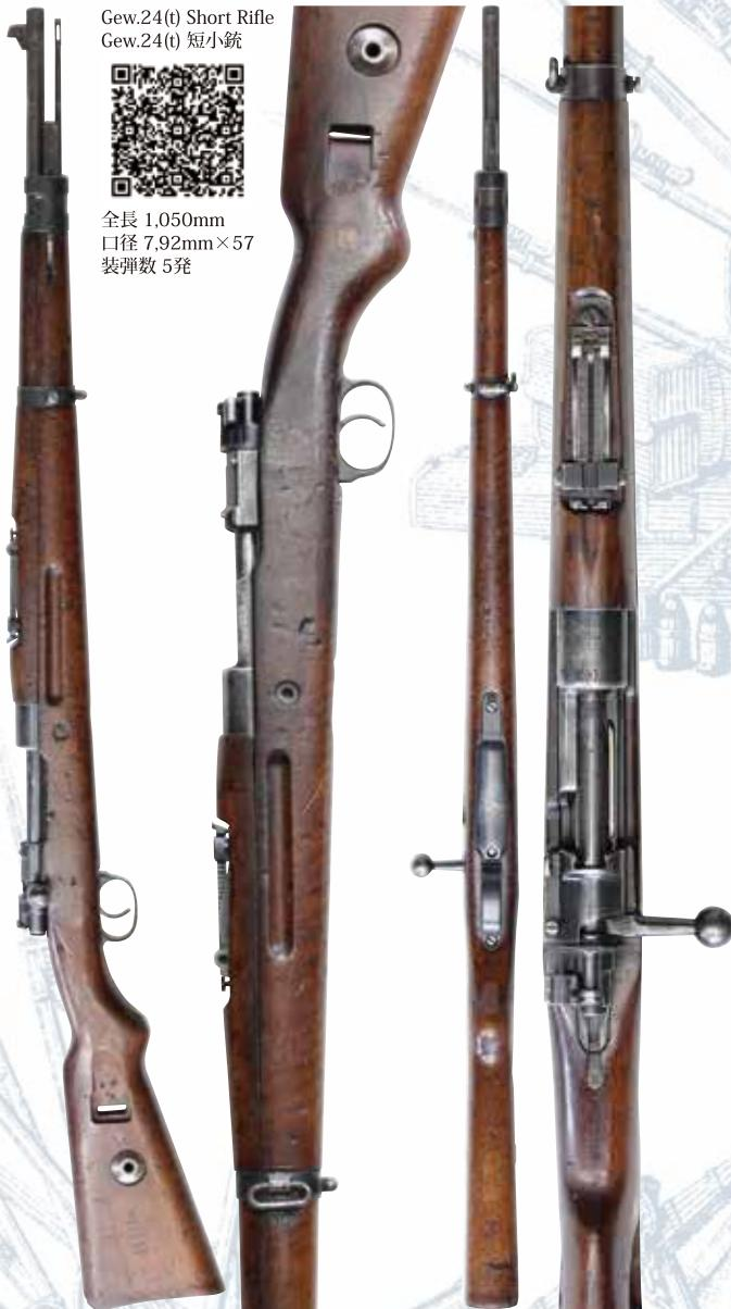
チェコスロバキアで開発されたVz.24小銃をドイツ軍仕様に改良し、第二次世界大戦中に生産されたモデルです。1938年のドイツによる併合当時、チェコスロバキアのPovažská Bystrica工場では国内向け及び輸出用としてVz.24の製造を行っていましたが、ドイツは併合後も枢軸国側のルーマニアから受注したVz.24の生産を同工場で続行する事を承認し、受注分の生産完了後はドイツ軍向けにGew.24(t)の製造に移行しました。Gew.24(t)ではストックにKar.98k小銃と同様のスリング取り付け穴及びボルト分解用ディスクが追加されており、銃剣はKar.98kと共通の物が使用可能です。初期生産品では銃床が単材製でしたが、その後合板製の銃床を装備した品も製造されました。また、1942年頃になるとフラット型バット・ブレードの部品枯渇に伴い、カップ型の物を取り付けて製造されました。Gew.24(t)は1941年から1942年にかけて約255,000挺が製造されましたが、その後戦前に製造された部品の在庫が枯渇した為、Kar.98kの生産へと完全に移行しました。
