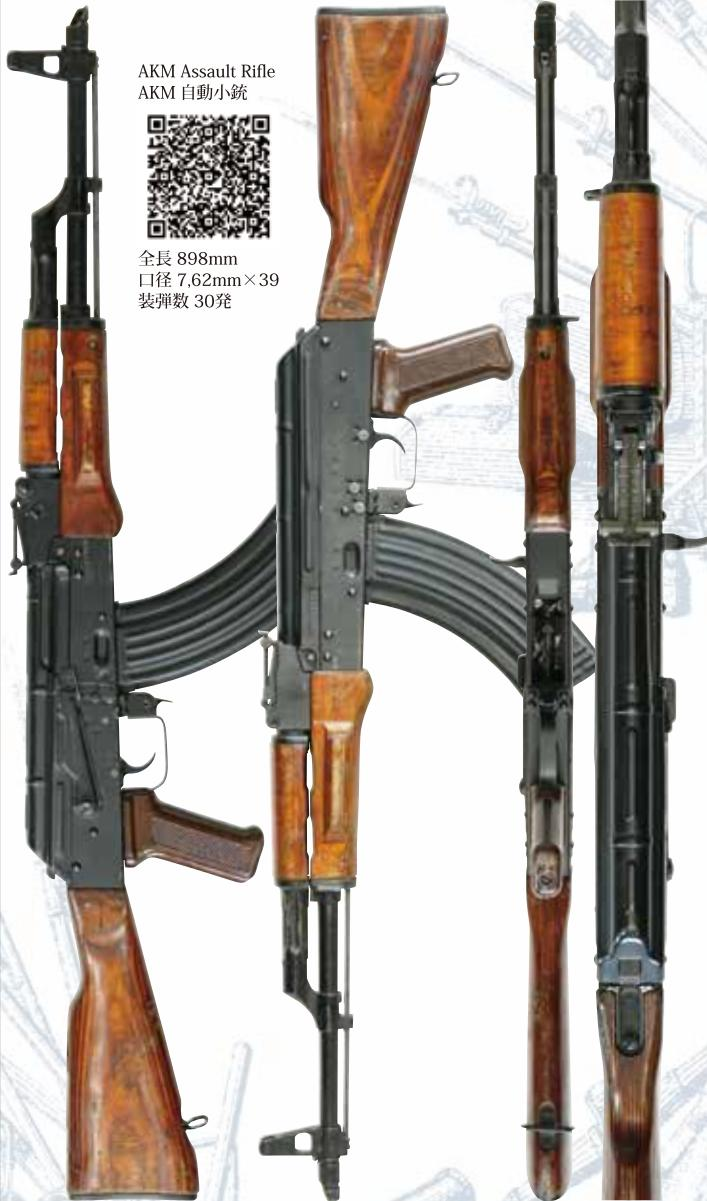
ミハエル・カラシニコフが設計したAK-47自動小銃の改良型で、1959年に旧ソ連軍により制式採用されました。基本構造はAK-47と同様ですが、レシーバーが削り出しからプレス製へと変更になり、生産性の向上と軽量化が図られています。フレームオートマチック射撃時の制御を容易にするため、ストックの形状も直銃床型へと変更された他、銃口部には斜めに切り落とされた形状のマズル・ブレーキが追加されたのも特徴です。また、トリガー機構にはボルトが完全に閉鎖するまでハンマー・リリースのタイミングを遅延させるための部品が追加されました。尚、リア・サイトの最大射程はAK-47では800mまでとなっていましたが、AKMでは1,000mまで延長されています。マガジン・ウェル上方のレシーバー両側面には本体強度の向上及びマガジンを正常な位置に固定する事を目的とした窪みが設けられています。AKM自動小銃は、旧東側諸国を始めとする諸外国でもライセンス生産が行われました。
