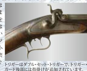
19世紀中頃にベルギーリエージュのMORAY社で製作されたと考えられる単発前装管打式歩兵銃です。一般的な管打式小銃とは異なり、本銃では銃身後端にバーカッション・ニップルが位置し、アッパー・タンクのハンマーにより撃発を行う構造となっているのが特徴です。このような構造の銃は英語で "In-line" と呼ばれ、製作工程の簡略化が可能ですが、発射ガスがニップル孔から後方に噴出する危険性を伴います。本銃のハンマーはグリップ・セーフティを握り込んだ状態でのみ落ちる構造となっていますが、撃発後はセーフティを解放しない限りハンマーが前進位置で固定され、銃身後端からの発射ガスの吹き戻しを防いでいます。また、工具を使わずに機関部と銃身を銃床から取り外せるのも特徴の一つです。全体の作りはフランス系のマスケットの流れを汲んでおり、銃床はチロル地方独特のチロリアン・バット・プレートと呼ばれるバット・プレート下部が突き出た形状をしています。
