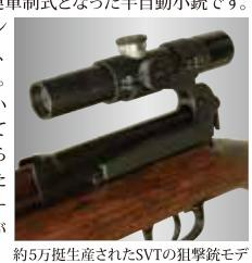
約5万挺生産されたSVTの狙撃銃モデルでは、レシーバーにPUスコープ・マウントを装着する事ができます。
