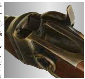
センター・ファイア・モデルのため、ブリーチ・ブロックにはファイアリング・ピン及びエキストラクリークが装備されています。
