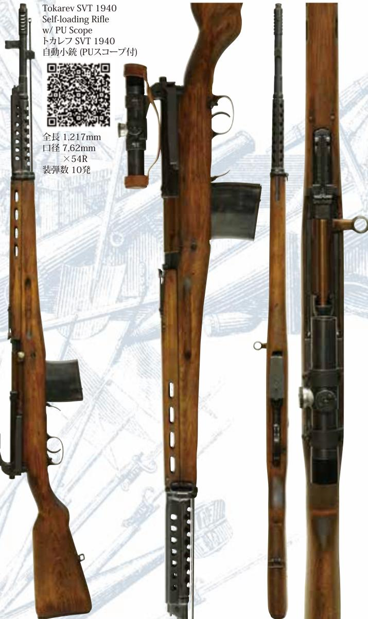
フョードル・トカラフ技師が設計したSVT 1938の改良型で、1940年に旧ソ連軍制式となった半自動小銃です。作動方式はショット・ストローク・ピストンによるガス圧利用式で、ティルティング・ボルト方式の閉鎖機構を備えています。弾薬の装填はマガジン交換の他、モシンナガン小銃用の5発クリップを用いて本体上部から行う事も可能でした。本銃は使用弾薬の性能や給弾不良等の問題を抱えていた他、モシンナガン小銃に比べて製造コストが高く、更に初步的な訓練を受けただけの兵士にとっては構造が複雑でメンテナンスが難しい銃でした。そのため徐々に生産数が減られ、1945年初頭には生産が終了しました。SVTには狙撃銃として使用するため、PUスコープを装着出来るバリエーションも製造されました。またバリエーションとしてフル・オートマチック射撃が可能なセレクティブ・ファイアのAVTが存在しましたが、耐久性等に問題があったため少數の生産に留まりました。
