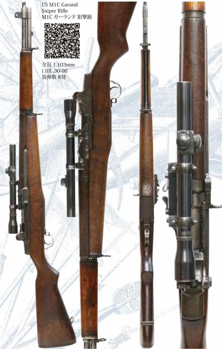
M1ガーランド ライフルに2.5倍スコープを取り付けた狙撃銃です。スコープ・マウントはネジ留めによりレシーバー左側面に直接固定されており、装着されるスコープはその後のM1D狙撃銃用のM84スコープとは異なるM81及びM82と呼ばれるタイプが使用されました。M1C狙撃銃は第二次世界大戦中にスプリングフィールド造兵廠だけで7,971挺製造されました。終戦までに実戦部隊へ配備されたかった為、大戦中には戦場での試験を行う事が出来ませんでした。その後の朝鮮戦争でM1Cは米陸軍の標準狙撃銃として配備され、追加で4,796挺が生産されました。実戦使用により最大有効射程が600ヤード（約550m）で、450ヤード（約400m）から600ヤードの距離でもある程度信頼できる性能がある事が証明されました。しかしながら、600ヤードの最大有効射程を得るには、マッチ・ターゲット弾を使用しなければ難しかったと言われています。M1C狙撃銃はベトナム戦争勃発時まで制式狙撃銃として使用されました。
