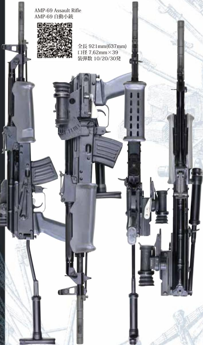
ハンガリー軍の将校用自動小銃として開発されたAMP-65をベースに、ライフル・グレネードの発射機能を追加したモデルです。本銃以外のAK系自動小銃にも銃口部にアタッチメントを装着してライフル・グレネードを発射可能なモデルは存在しますが、小型軽量なAKでは発射時のリコイルが非常に強く、実用的とは言えませんでした。そこでハンガリー軍特殊部隊からの要望で、グレネード・ランチャーとしての機能を優先させつつ、自動小銃としての性能も維持出来るモデルとして1969年に開発されたのがAMP-69です。発射時のリコイルを軽減する為、折り畳み式スティックにショック・アブソーバーが組み込まれている他、ハンドガードはスプリングにより前後に可動し、グレネード発射時に添え手が弾かれる事を防いでいます。更にガス・カットオフ・スイッチの追加や、グレネード発射時の衝撃によりレーサー・バーが外れないようロック機能が装備されているのも特徴です。
