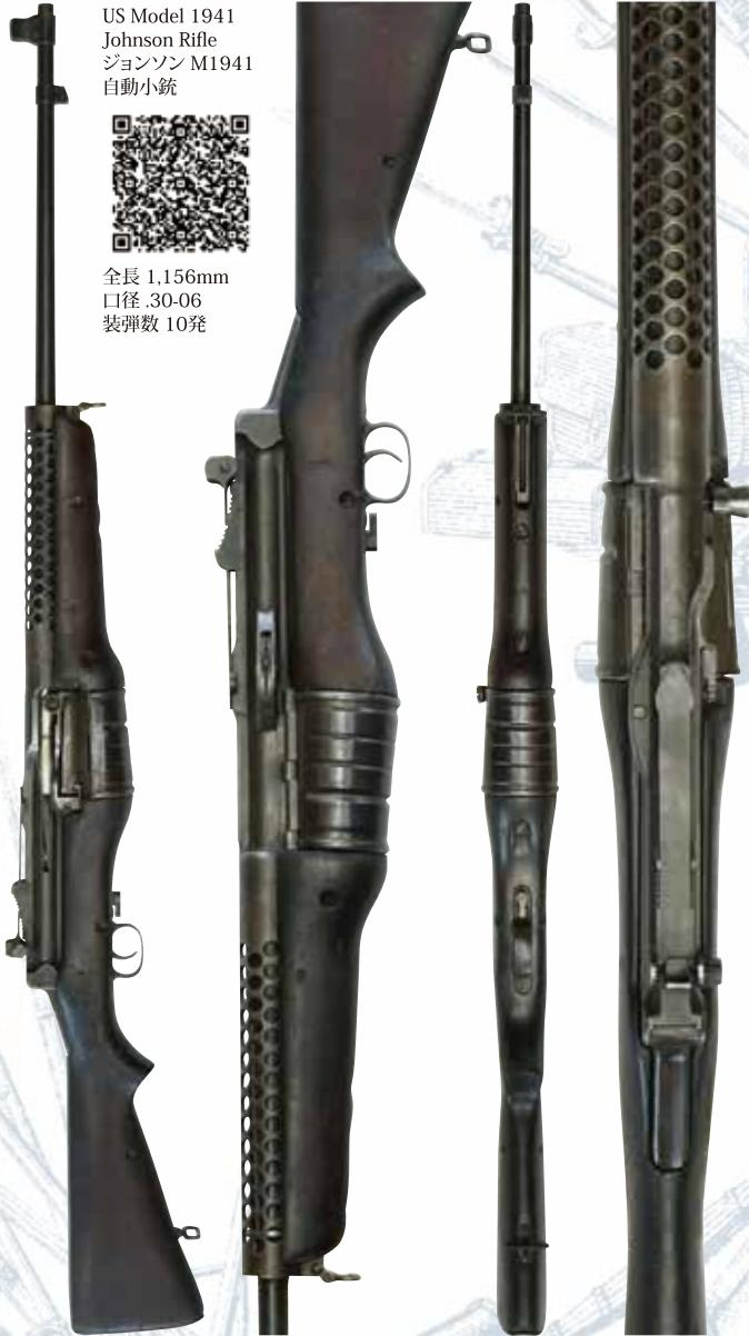
メルヴィン・C・ジョンソンが設計し、1941年に米海兵隊の空挺部隊など一部が採用した自動小銃です。作動方式は反動利用のショート・リコイル式で、8個のロッキング・ラグによるローテイティング・ボルト式の閉鎖機構を持ち、特徴的な回転式弾倉を装備するなど、特殊な構造を備えています。M1ガーランドライフルに比べて反動が小さく、装弾数が10発と弾倉容量の点でも有利であった他、弾倉に弾薬が残っておりかつボルトが閉鎖状態であっても弾薬を追加装填できるといった点で優れていました。しかしながら、本銃は上下方向の集弾性が分散した他、M1ガーランドに比べて細かい部品が多く、通常分解時にそれらを紛失する恐れがありました。また、重量のある銃剣を銃身に装着した際に作動不良が発生する恐れがあった為、専用のスパイク銃剣が用意されていました。本銃は海兵隊が増産を求めたものの、結果的に第二次世界大戦中3万挺ほどが生産されたに留まりました。
