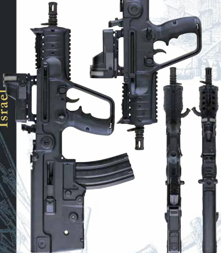
イスラエル・ウェポン・インダストリーズ (IWI) により開発された、コンパクトなサイズのアサルト・カービンです。当初はタボールTAR-21自動小銃のバリエーションとして、マイクロ・タボールの名称で販売されました。現在ではX95として従来のタボール・シリーズから独立した派生モデル扱いとされています。作動方式はTAR-21と同様にロング・ストローク・ピストンのガス圧利用式で、ローテイティング・ボルト式の閉鎖機構を備えています。グリップ上部に設けられたセレクター・レバーはアンビ・タイプとなっており、コッキング・ハンドルや排莢の方向も使用者の好みに応じて左右で変更する事ができます。また、フレック式でありながらトリガー・ガード上部の両面にマガジン・リース・ボタンが設けられているのも特徴です。X95は9mm×19弾仕様の短機関銃モデルなど口径の異なるバリエーション展開も行われており、9mmモデルでは作動方式がブローバック方式となっています。
