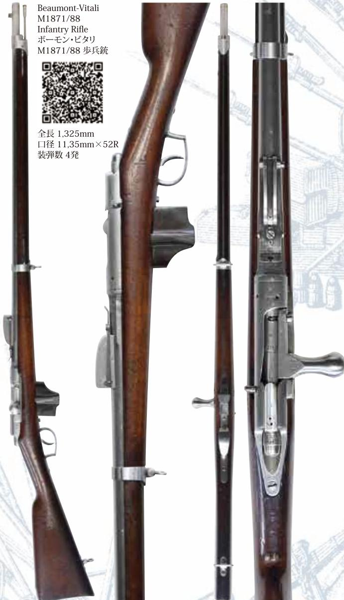
ボーモン小銃はオランダ軍が初めて採用した、当初から金属製薬莢を使用する目的で開発された小銃です。1888年には、単発式のボーモンM1871小銃にイタリアで考案されたビタリ式の固定式4連マガジンを追加して連発式としたボーモン・ビタリM1871/88小銃が採用され、1888年から1890年にかけて約6万挺のボーモンM1871に対して改修が施されました。ボーモン小銃のボルトに使用されるメイン・スプリングには、コイル・スプリングではなく、V字型の松葉バネが用いられています。ボルト・ハンドルは内部にこの松葉バネが組み込まれているため、2つの部品を左右から合わせた構造となっています。この構造はストレート形状のボルト・ハンドルのみに対応しており、騎兵銃など曲がった形状の物には使用出来ませんでした。そのためオランダ軍はボーモン小銃を歩兵用とし、レミントン社からライセンスを受けて生産したローリング・ブロッケ・カービンを騎兵や砲兵用として採用しました。
