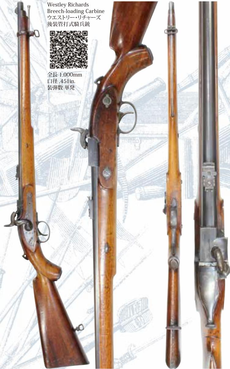
英國陸軍で前装式のエンフィールド小銃を後装式に改良するトライアルに提出された後装式小銃の一つです。本銃の後装方式は、猿の尻尾（モンキー・テイル）に似たツマミを引き上げることによってブリーチを開き、そこから紙薬包式の弾薬を装填します。尚、弾薬の装填操作とは別に、ハーフ・コック状態でバーカッション・ニップルに雷管を被せる必要がありました。本銃は構造が複雑で製造コストが高かった事から、結果的には改良が容易で安価かつ堅牢な構造のスナイドル小銃が採用されました。しかしながら、スナイドル小銃が制式採用されるまでモント・ストーム小銃に並び有力な候補であった為、英國陸軍省では2,000挺を購入し、騎兵用に支給しました。また、英軍の次期制式小銃の座を逃した後も、ポルトガル軍や南アフリカのボア軍を始め諸外国の軍隊で使用されました。本品はフル・ピストル・グリップ・タイプのストックが付いた非常に珍しい特注品です。
