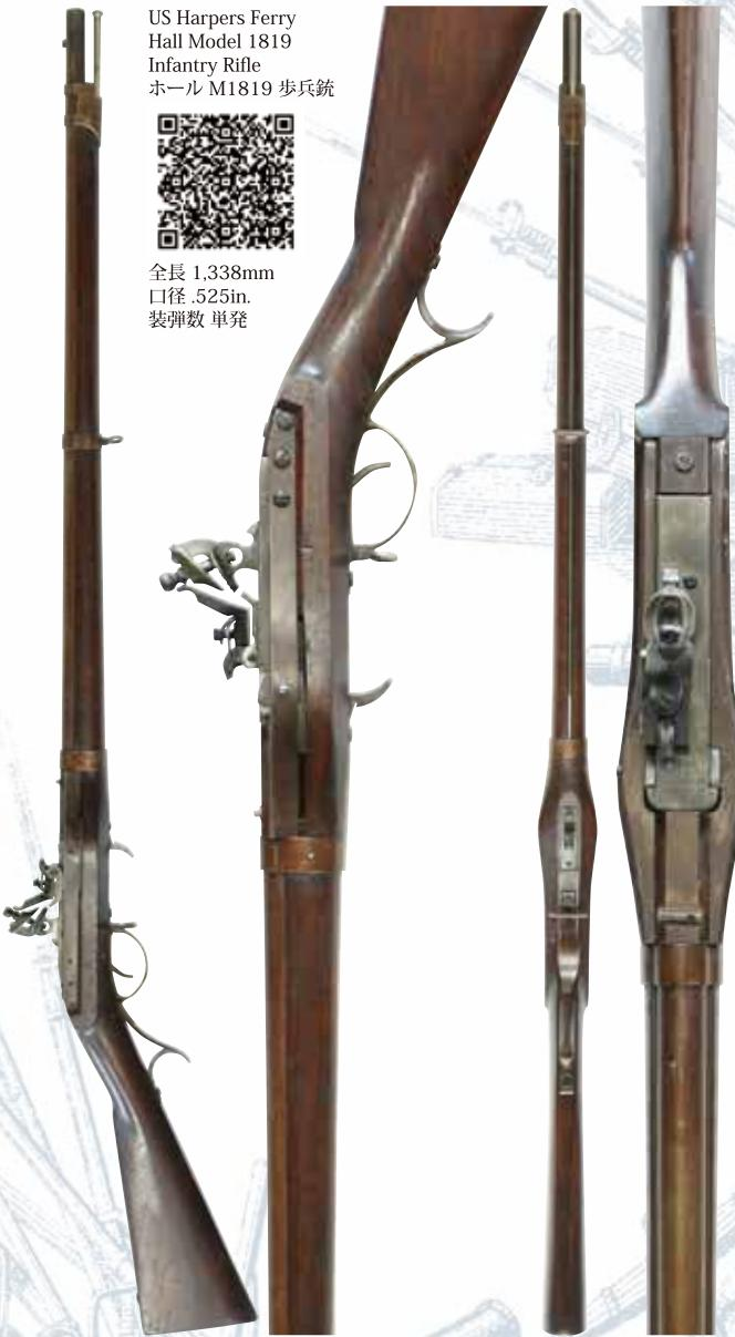
フリント・ロック(火打石式)の時代に後装式の装填機構を取り入れた画期的な小銃で、量産された世界初の軍用後装式小銃となりました。本体下部に設けられたレバーを後方に押してロックを解除しながら上方に持ち上げる事により、撃発機構が組み込まれたブリーチ・ブロックが上昇し、薬室部前方から弾丸と発射薬が直接装填可能となる特殊な後装システムを備えています。このホール式の後装機構はジョン・H・ホールによって設計され、1811年5月21日に特許が取得されました。その後1819年にホールM1819小銃はハーパーズ・フェリーM1803小銃の後継統として合衆国陸軍によって採用されました。ホールM1819歩兵銃の銃身長は32.5インチ(約82.5cm)で、銃身内には16条右回りのライフリングが刻まれていましたが、銃口部分から1.5インチ(約3.8cm)程は滑腔銃身となっていました。ホール小銃の製造はハーパーズ・フェリー造兵廠で行われ、1820年から1830年代までに23,500挺の歩兵銃が生産されました。
