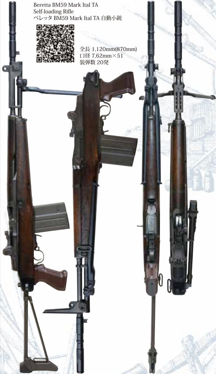
イタリアのベレッタ社は第二次世界大戦後、西ヨーロッパ諸国及び自國の武裝の為に主力小銃として配備されていたM1ガーランド小銃のライセンス生産を行いましたが、このM1ガーランドを基に使用弾薬を7.62mm×51 NATO弾とし、全長の短縮化及びセレクティブ・ファイア機能の追加を行ったのがBM59です。当初はイタリア軍に配備されていた既存のM1ガーランドを改造する形で生産が行われましたが、その後はベレッタ社による新規製造に移行しました。銃口部には消炎器と制退器を兼ねた擲弾発射機を取り付けられており、ガス・カットオフ・スイッチ兼用のライフル・グレネード・サイトも装備しています。また、内部部品の切り替えにより射撃機能をセミ・オートマチックのみに限定する機構も備えています。Mark I~IVまで開発されたBM59シリーズの内、山岳部隊用モデルはMark IIIもしくはMark Ital TAと呼ばれ、金属製の折り畳みストックとピストル・グリップを装備しているのが特徴です。
