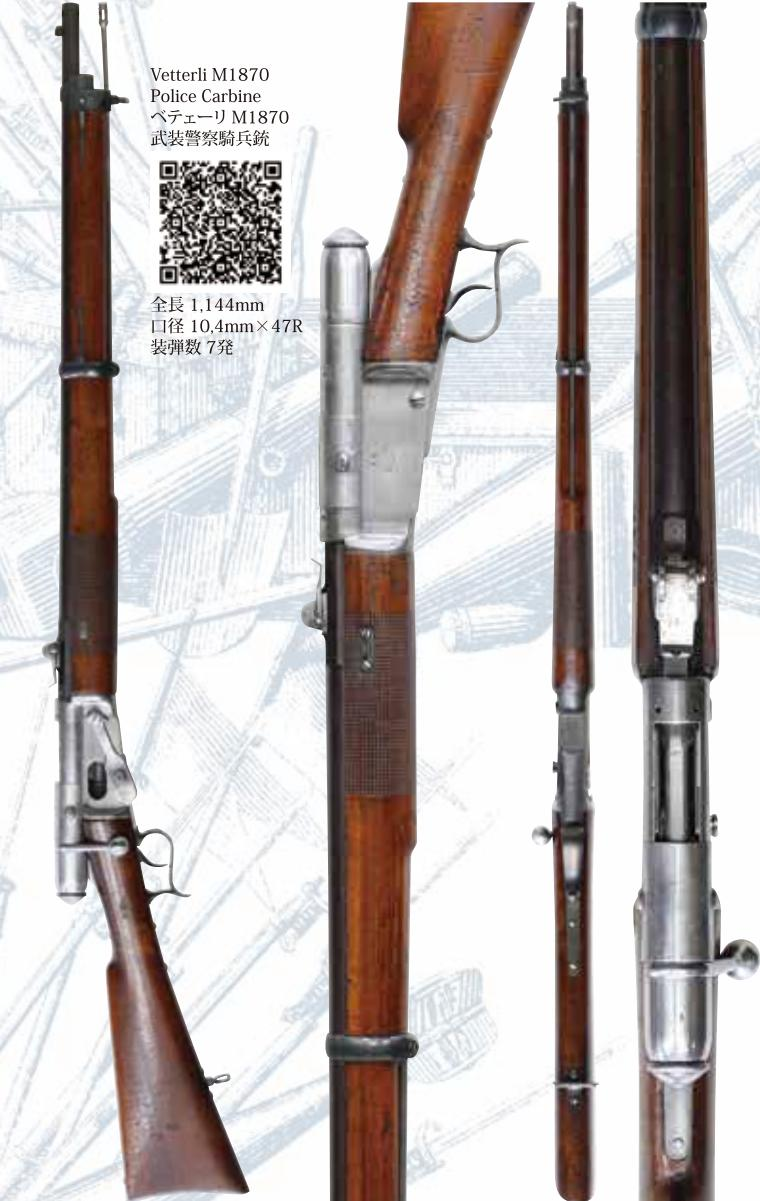
ベテューリ小銃は1869年から1889年にかけてのスイス軍主力小銃です。給弾機構は給弾エレベーターと銃身下部のチューブ型弾倉から成り、レシーバー右側面の給弾孔から給弾を行います。一般的なボルト・アクション機構とは異なり、ベテューリ小銃ではボルト自体は回転せず、ボルト・カラーと呼ばれるチューブ状の部品がボルト・ハンドルと一体になって回転し、ボルト・カラー後部の突起がロッキング・ラグとして機能しました。1870年に採用されたベテューリM1870武装警察騎兵銃は、ジャンダルムリ(Gendarmerie)と呼ばれる武装警察の騎馬部隊用に改良された一種の騎兵銃で、歩兵銃の特徴を備えつつも全長を歩兵銃と騎兵銃の中間サイズとして取り回しを容易にしています。尚、歩兵銃の装弾数が11発であったのに対し、武装警察騎兵銃では銃身長の短縮に伴い7発に減少しています。また、給弾孔カバーや遊底覆を装備するなど、初期のベテューリ小銃の特徴をよく残しています。
