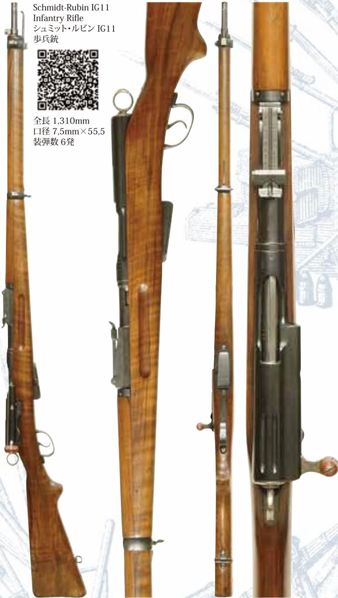
シュミット・ルビン小銃は、スイス軍のシュミット大佐(銃担当)とルビン大佐(弾薬担当)が共同で開発したストレート・ブル式ボルト・アクション・ライフルです。同じくストレート・ブル方式であるオーストリアのマンリッヒャー方式とは異なり、ボルト・ハンドルを引くとボルト・スリーブ内のボルト部分のみが90度回転する独特の構造になっています。1911年にスイス軍制式となったIG11歩兵銃は、IG89歩兵銃の改良型であるIG89/96歩兵銃のストック下部にスキャント・グリップを追加したIG96/11歩兵銃と外観が似ていますが、IG11歩兵銃ではストックとスキャント・グリップが一体型になっている点で判別可能です。また新型のGP11弾に対応する為、機関部の内部構造にも改良が加えられています。IG11を含むシュミット・ルビン系小銃は、その複雑なストレート・ブル方式が原因でボルトの強度不足が懸念とされ、その解決には後継モデルであるK31小銃の登場を待たねばなりませんでした。付属の鎌剣(切断済合法品)は、銃本体とシリアルNo.がマッチしています。
