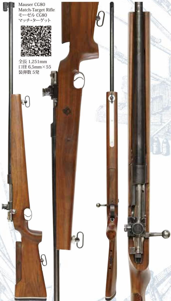
スウェーデン軍制式小銃であったモーゼル M1896 系の機関部を用いて開発された競射競技専用銃です。一連のシリーズとして CG63、CG73、CG80 が開発され、スウェーデン軍及び FSR と呼ばれる射撃競技団体で使用されました。CG63 は 1963 年にモーゼル M1896 小銃をベースに、新造されたフリー・フローティング のヘビー・バレルとセミ・ピストル・グリップ付のストック、そしてマイクロ・スター・サイト を装備してカール・ゲスタフ工廠及びノルマ社で製造されました。CG63 ではロック・タイム短縮の為、コッキング・ピースの軽量化及び作動ストロークの短縮化が行われています。1973 年にはストックを改良したモデルが CG73 として使用されました。CG63 との差異は僅かであったため軍では区別されませんでした。その後、1980 年には重量を更に増したヘビー・バレル の他、調整可能なチーク・ピースを備えたストックや、CG63 に比べてより精密なマイクロ・スター・サイト を装備した CG80 が採用されました。
