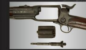
ハーフ・コック状態でフレーム左側面のボタンを押し込みながらシリnder一軸を後方に引き抜く事により、シリnderの取り外しが可能です。
