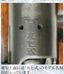
九九式短小銃は世界各国の主力小銃短縮化の流れに従い、九九式小銃(長小銃)よりも全長が約140mm短い歩兵銃と騎銃の中間サイズのモデルとして、昭和14年に九九式小銃と共に仮制式制定となった小銃です。その後、九九式小銃(長小銃)は生産が早期に終しましたが、九九式短小銃は主力小銃として終戦時までに約250万挺が製造されました。九九式短小銃は当時の日本の状況を反映するように生産時期によって細部の仕様が異なり、特に初期型と末期型では品質や各部の仕様に顕著な違いが見られます。末期型では照尺(リアサイト)が固定式のピープ・サイトとなっているのが大きな特徴です。その他にも銃床が下帯(リア・バンド)位置で分離式となり、木被(アッパー・ハンド・ガード)が下帯までの長さに短縮された他、床尾板(バット・プレート)が木製となるなど、生産性の向上や資源節約の為の仕様変更が各部に見られ、バリエーションにも富んでいます。
