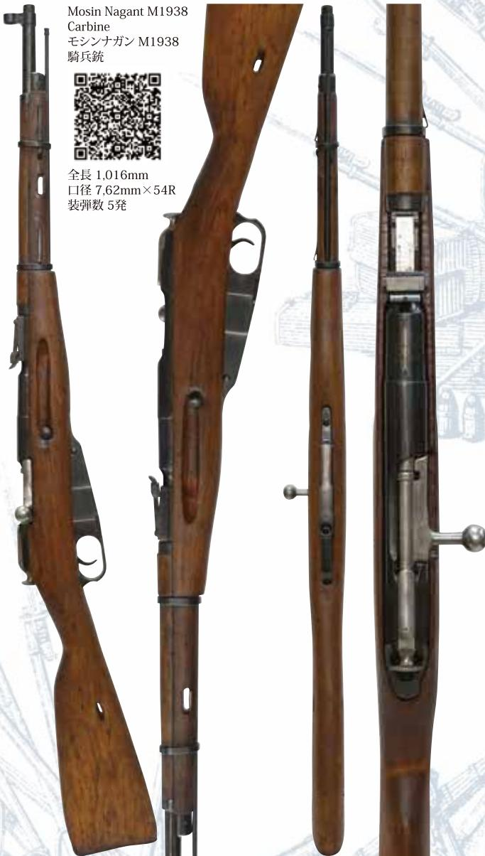
モシンナガンM1891/30歩兵銃を基に設計された騎兵銃モデルで、主に砲兵部隊や後方部隊等に配備されました。M1891/30歩兵銃に比べて銃身や銃床前部、ハンドガードが短縮化された他、着剣機能が省略されています。銃身の短縮に伴いクリーニング・ロッドも短縮された他、リア・サイトの最大射程についてもM1891/30歩兵銃の2,000mに対してM1938騎兵銃では1,000mへと変更されています。また、M1891/30歩兵銃では銃身にフロント・サイト・ベースがろう接によって直接取り付けられていたが、M1938騎兵銃ではスリーブ状のフロント・サイト・ベースを銃身に圧入した後、ピンにより側面から固定する構造へと変更されています。M1938騎兵銃は1939年から1945年にかけて主にイジェフスク造兵廠で製造された他、ツーラ造兵廠でも1940年と1944年に製造が行われました。1944年に側面折り畳み式のスパイク銃剣を備えたモシンナガンM1944騎兵銃が導入されると、M1944騎兵銃と同型の銃床を取り付けたM1938騎兵銃も製造されました。
