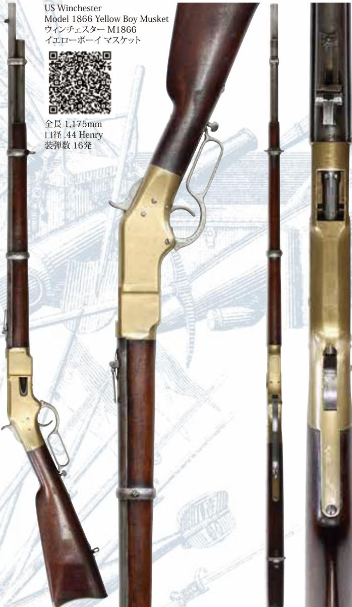
ウェインチェスター社で製造されたM1866（イエローボーイ）には、銃身長が20インチのカービンの他に、24インチのライフル・モデル、そして27インチのマスケット（歩兵銃）・モデルが存在します。マスケット・モデルでは銃身が3本のバレル・バンド（マガジン・チューブ1箇所、ハンドガード2箇所）により固定されており、マガジン・チューブ先端より約10cm突出した銃身先端部分にソケット式のスパイク銃剣が装着可能となっているのが特徴です。ウェインチェスター社はマスケット・モデルが軍用として採用される事を期待して営業活動に力を注ぎましたが、結果的に合衆国政府では採用されませんでした。その為、マスケット・モデルの生産量は僅か14,000挺程度に留まりましたが、その多くが当時オスマン帝国であったトルコに輸出されてロシア帝国との露土戦争（1870-71年）で使用され、その連発性能が世界的に評価されました。
