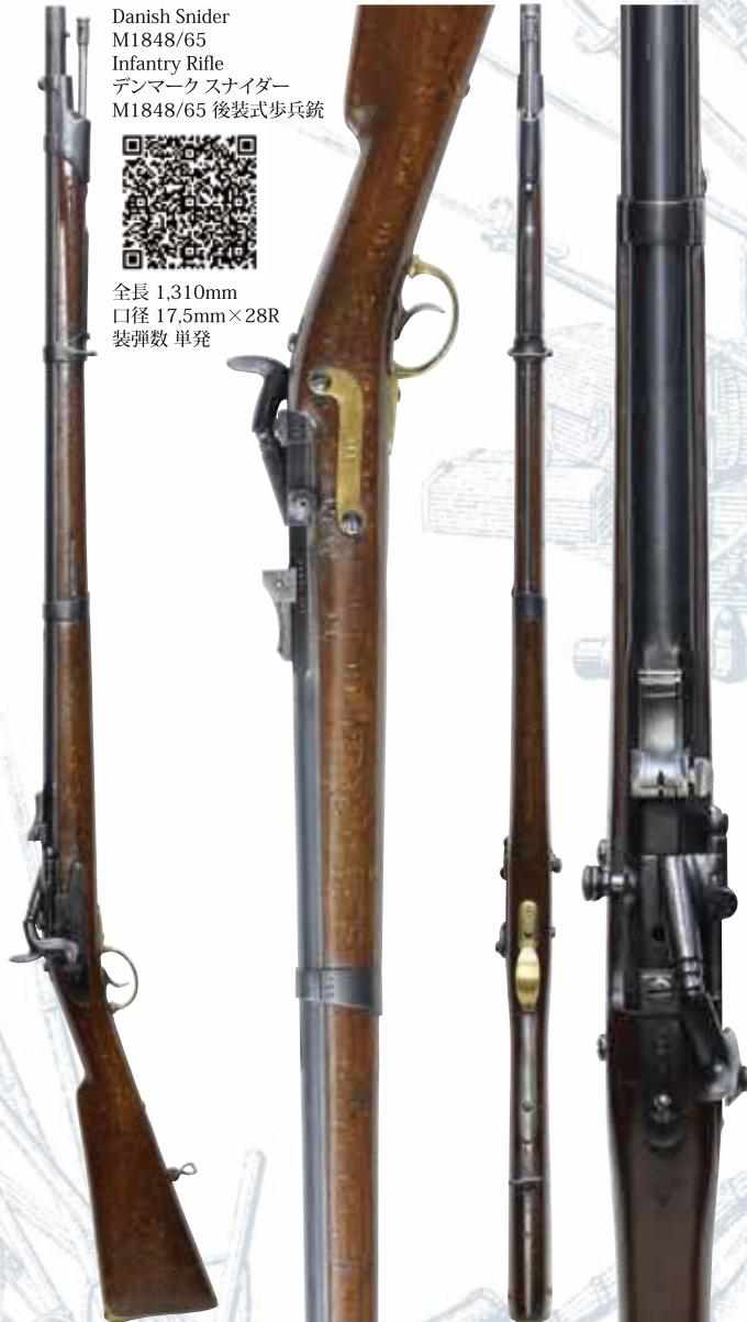
デンマーク軍制式のM1848前装式小銃をベースに、スナイダー方式の後装システムを用いて後装式に改修を行ったモデルです。M1848小銃の銃身後部（薬室）の上部を切除した後、右方向に開く蝶番式ブリーチ・ブロックを追加しています。ブリーチ・ブロックには撃針が組み込まれており、M1848小銃から流用されたサイド・ロック式の撃鉄で撃発を行います。この改修はコペンハーゲン造兵廠で1866年から1868年にかけて行われました。デンマークではM1867ローリング・ブロック小銃の採用後も軍への配備が遅れた事から、既存の前装式小銃をスナイダー方式に改修して引き続き運用しました。M1848小銃をベースに改修された後装式小銃としては、3バンドのM1848/65歩兵銃の他、デンマーク海軍向けにM1848小銃から改修されたM1853海軍用小銃を基にスナイダー方式へと改修したM1853/66海軍用小銃が存在します。歩兵銃と海軍用小銃共に、特徴的なアーチ状のダルホフ（Dahlhoff）・タイプのリア・サイトが取り付けられています。
