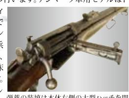
弾薬の装填は本体右側の大型ハッチを開いて一発ずつ行います。装填操作はボルトが閉鎖状態でも可能です。
