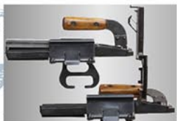
箱型のベルト給弾ユニットは、コッキング・ハンドルに連動してアム・ベルトの送弾を行います。
