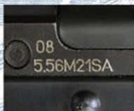
本体左側面には口径及びモデル名を示す刻印が入っています。
