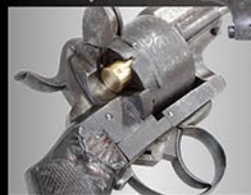
ローディング・ゲートを開いてピンファイア・カートリッジの装填を行います。
