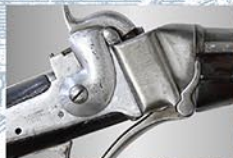
スラント・ブリーチモデルの斜め下方へ下降するブリーチ・ブロック
