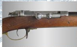
ボルトはレバー右側面のボルト・ガイドの切り欠きとボルト・ハンドル基部によって閉鎖されます。
