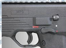
セクター・ポジションのあるセクター・レバーに加え、トリガー・セーフティが組み込まれています。
