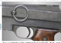
ボルトは銃身に対して斜め後方に後退します。リアサイトを折り畳むと本体上面がフラットになるのも特徴です。
