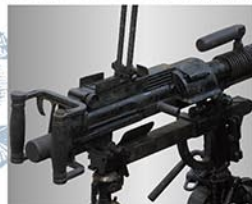
トリガーは左右のスバード・グリップ前方に装備されています。アモバベルトは本体右側から給弾されます。
