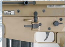
レシーバー・レシーバーはアルミニウム合金製、ロー・レシーバーは鋼製となっています。
