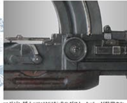
マガジン挿入口には回転式のダストカバーが装備されています。マガジン・リリースレバーは後に折り畳み可能です。
