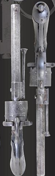
ローディング・ゲートを開いてピンファイア・カートリッジの装填を行います。
