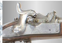
ハンマーを起倒した状態でブリーチ・ブロック右側面のハンドルを持ち上げる事により薬室を開放します。
