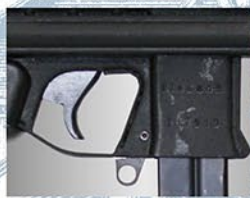
マガジン・リコー・スレーはマガジン・ハウジング後方に設けられています。
