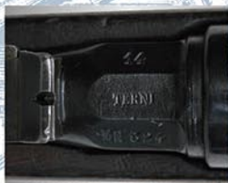
本銃体の薬室上面にはTermini工廠で製造された事を示す印が入っています。
