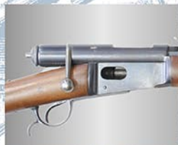
装弾は本体右側面のローディング・ガードから行い、発射時の薬室は本体上面から露出されます。
