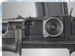
リア・サイト調整用ダイヤルはZB系軽機関銃と同様、マガジンハウジング側面に設けられています。
