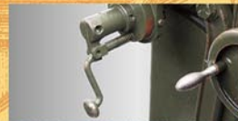
基部のハンドルを操作する事で、ブンカー・マウントを引きおろす事ができます。
