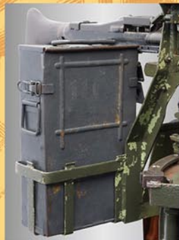
ブンカー・マウントには、スムーズに装填できるよう内部に複数の仕切りを設けた250発弾薬箱を用います。
