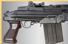
Mark Ital TA自動小銃では、本体右側にストックを折り込む事が可能です。
