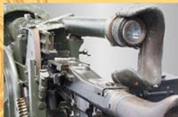
装填の際、フィード・カバラーに下移しないようベリスコープをオフセットする事ができます。
