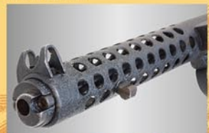
バレル・ジャケット左側面には着剣ラグが設けられています。
