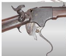
スペンサー M1865 騎兵銃のレバーを引いてブリーチ・ブロックが下がった状態の機関部
