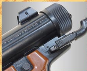
レシーバー後面には折り畳みストックのロック・ボタンが設けられています。
