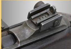
リア・サイトは折り出して製品されたアジャスタブル・タイプの物が取り付けられています。
