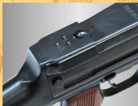
フィードカバーは後部のロックを前方にスライドさせる事で開きます。
