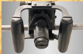
ボルト・ワッシャー・リリース・ロックを切り替える事により、セミ・オートマチック射撃の切り替えを行います。
