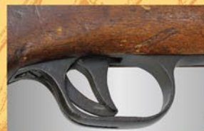
トリガーは引き方に応じてセミ・フル・オートマチック射撃の切り替えが可能です。
