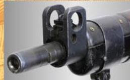
Short, Magazine Lee-Enfield Rifle No.4 Mk I No.4 Mk Iは、リア・サイトが機関部後部に移り、ストックより僅かに突出した銃身先端にスパイク・ハコネットを装着するようになった品です。No.4 Mk Iの生産性向上型であるNo.4 Mk I*は、リア・サイトをヒープ・サイドとして射程距離が500mまでに限定されているのが特徴です。大戦中は英国造兵廠の多くがドイツ軍の爆撃にさらされた為、SMLEやブレンガンを始め多くの英軍用銃がカナダ等で生産されました。また、No.4 Mk Iはアメリカのサバード社でも製造が行われ、レントリース法に基づきイギリスに供給が行われました。
