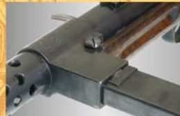
マガジン・リリースはボタン式で、マガジン・ハウジング上面に設けられています。
