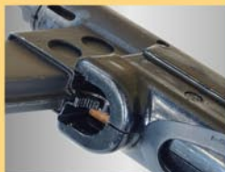
マガジン・リリースはMP40のようなボタン式ではなく、レバー式となっています。
