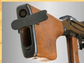
バレル・ブレイク内にはクリーニング・キットの収納スペースが設けられています。
