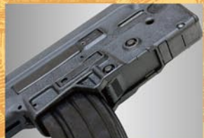
ホルト・リリースはマガジン・ハウジングの後面に設けられています。
