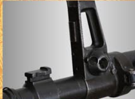
フロント・サイト・ポストにはグレネード用照準器を装着する為の突起及びガス・レギュレーターのダイヤルが設けられています。
