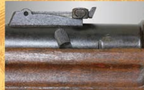
レシーバー左側面にはセーフティ・レバーが取付けられています。
