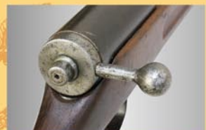
ホルト・アクション・ライフルと同様の特徴的なコッキング・ハンドルを備えています。
