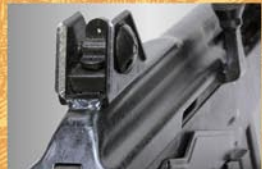
リア・サイトは二段切り替え式のプリファイトタイプの物が装備されています。
