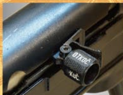
本体右側面のコッキング・ハンドルを内側に押し込む事によりボルトが固定されます。
