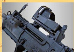
バックアップ用として、折り畳み式のフロントリア・サイトが装備されています。
