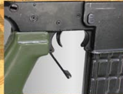
トリガー・ガードは前部のロックを解除する事により下方に開きます。
