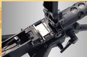
フィード・カバーは後部のワッシャーを解除する事により開閉が可能です。
