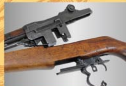
トリガー・ガードを下げる事により、銃床から機関部を直の引き出す事が可能となります。
