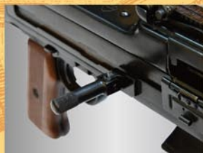
コッキング・ハンドルはボルト・キャリアと非連動式のタイプで折り畳みが可能です。
