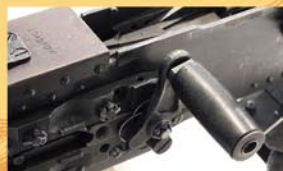
トリガー・ハウジングとスライド・グリップは黒色鍍金塗装の物を取り付けられています。
