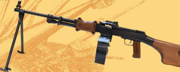
フィードカバーは後部のロックを前方にスライドさせる事で開きます。
