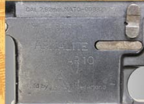
レシーバー左側面にはモデル名やAI社のロゴの他に、目撃表示の刻印が入っています。また、ボルト・リリースの形状が小判型に変更されています。
