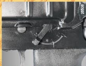
セクター表示は1(準射)・0(安全位置)・20(連射)の数字で表す。本体下面には製造年及びシリアルNo.が打刻されています。
