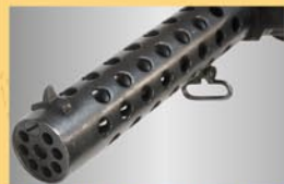
銃口周辺のバレル・ジャケットには放熱孔が設けられています。
