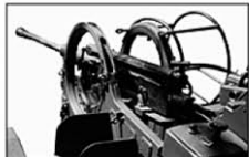
銃本体と機関部のクローズ・アップ。銃の右側面には空襲警戒用のバスケットが付属しています。
