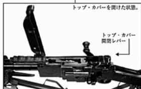
トップ・カバーは機関銃後部のレバーを回すだけで簡単に開閉できます。また、このトップ・カバー開閉レバーを抜くことにより、ローアー・レシーバーとアンダー・レシーバーが分離します。この方法は現代のエアソフトライフルでも用いられており、戦場での整備には便利に構造でした。
